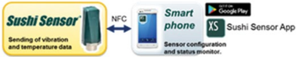
รูปที่ 2 การใช้โทรศัพท์มือถือสมาร์ทโฟนผ่านแอป Sushi Sensor App
