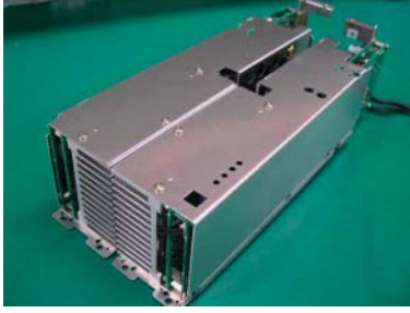
図3 アナログ部のモジュール構造
