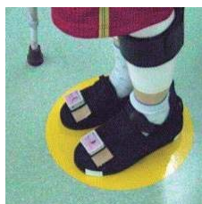
図8 歩行計測センサーを靴に装着したところ
