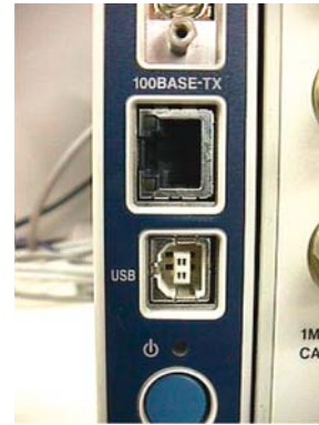
図3 USB インターフェース部及びイーサネットインターフェース部
