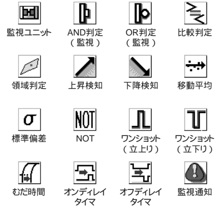
監視用工程部品例
