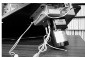
図6 ゲーム機cSEGA1999 (株式会社セガ・エンタープライゼス殿ご提供) ・上記に使用されているインダクションモータの仕様 モータ出力: 3W 連続運転 ギヤヘッド許容トルク: 1.4 N・m 寿命: 5,000時間
