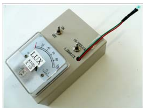
完成した照度計
