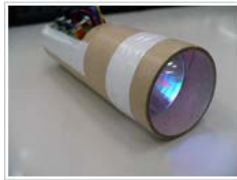
はんだ付けを行い、赤・青・緑の 発光ダイオードと基板をつなぎ、 懐中電灯の枠に組み込んで完成です
