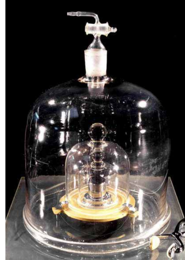
パリ近郊の Saint-Cloud の Pavillon de Breteuil にある 国際キログラム原器
