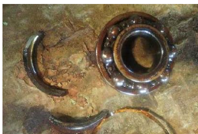
破損したベアリング
