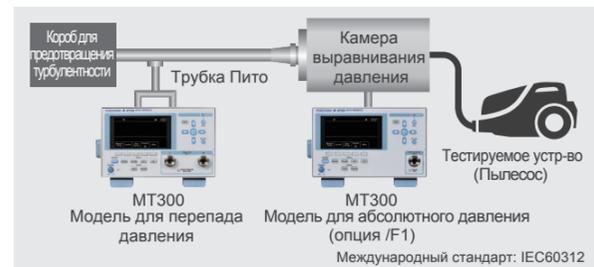
Тестирование мощности всасывания пылесоса
