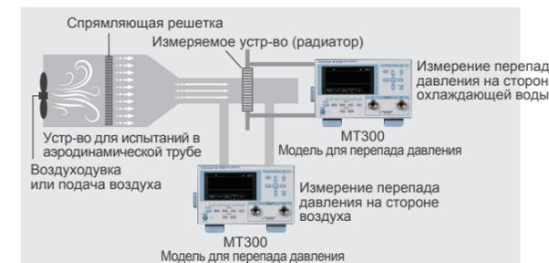
Для описанных выше приложений, использующих несколько манометров, с помощью функции синхронных измерений можно выполнять более точные измерения давления.
