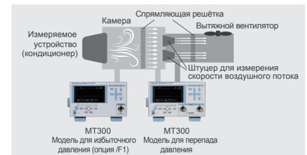
**Измерение потери давления с помощью одного устройства**
