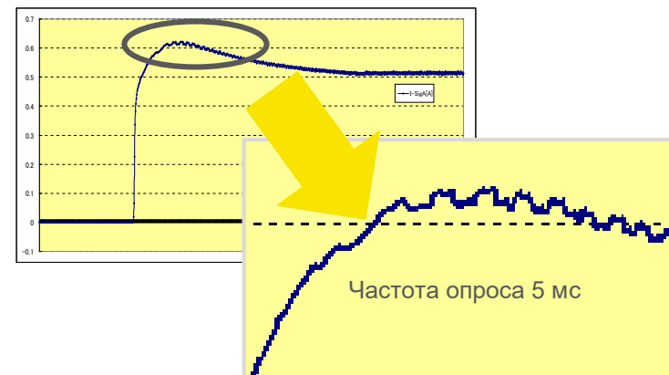
WT1800E Высокоскоростной сбор данных, с интервалом в 5мс
