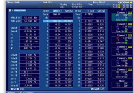
Высокопроизводительный анализатор мощности WT1800E
