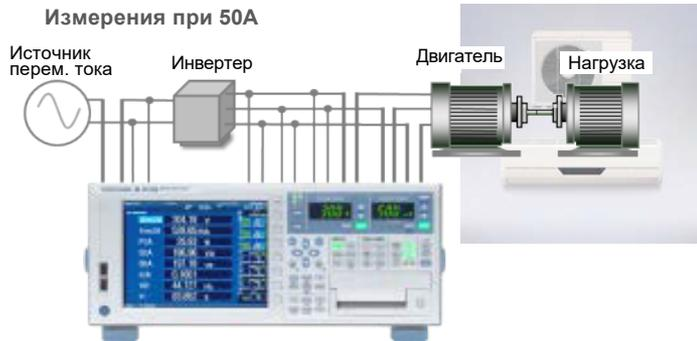
Измерение КПД сигнала входа и выхода
