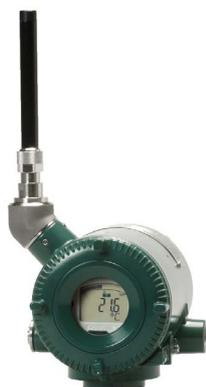
Преобразователи измерительные моделей УТА510 предназначены для преобразования сигналов, поступающих от термометров сопротивления, термопар, омических устройств, милливольтовых устройств постоянного тока, в унифицированный открытый промышленный протокол связи: ISA 100.11a для дальнейшей передачи по беспроводному соединению.
