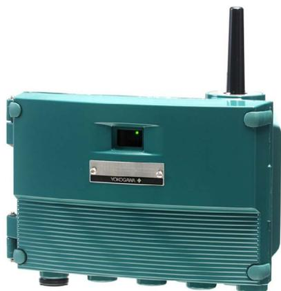
Многоканальный беспроводной преобразователь температуры YTMX580 имеет 8 универсальных измерительных каналов и предназначен для преобразования сигналов от термопар и термометров сопротивления, а также сигналов постоянного тока, напряжения и сопротивления в беспроводной сигнал в соответствии со стандартом ISA 100.11a для передачи данных удаленным системам регистрации и управления.
