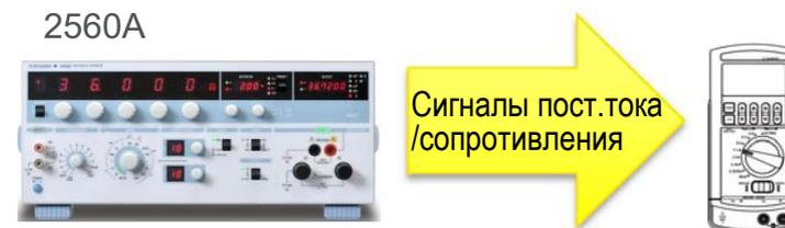
\* В зависимости от функций устройств, таких как специальный термопреобразователь сопротивления, высокое сопротивление, частота и т.д., некоторые функции не могут быть воспроизведены и откалиброваны с помощью 2560A. Более подробные характеристики приведены в каталоге нашей продукции.
