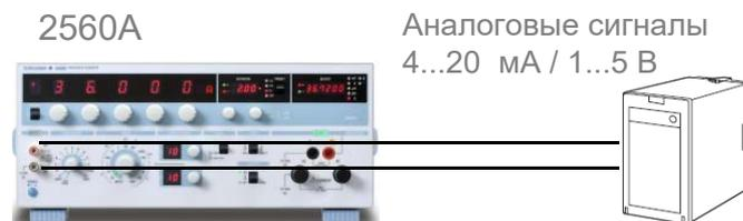
\* В зависимости от функций устройств, таких как специальный термопреобразователь сопротивления, высокое сопротивление, частота и т.д., некоторые функции не могут быть воспроизведены и откалиброваны с помощью 2560A. Более подробные характеристики приведены в каталоге нашей продукции. Для измерения выходных сигналов формирователя сигналов необходимо использовать цифровой мультиметр.
