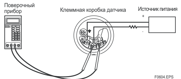
Рисунок 6.7 Подсоединение поверочного прибора
