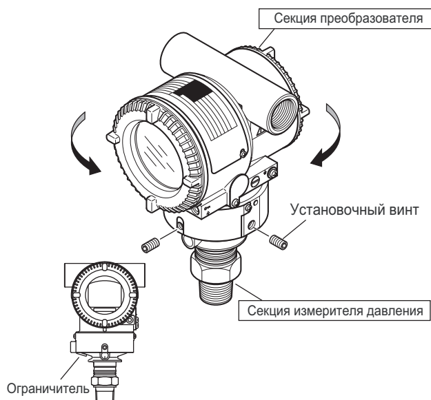
Рисунок 4.4 Вращение секции преобразователя
