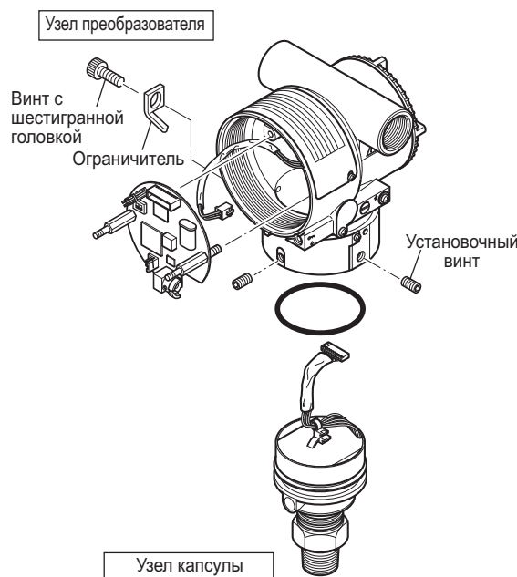
Рисунок 8.4 Демонтаж и монтаж узла капсулы (чувствительного элемента)
