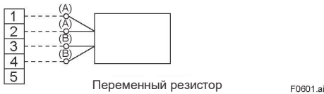
Рисунок 6.1 Пример подключения оборудования для калибровки
