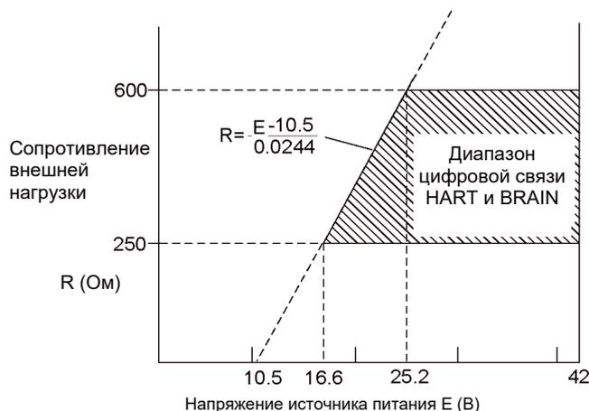
**Рисунок 1. Связь между напряжением источника питания и сопротивлением внешней нагрузки****Тип Fieldbus**
