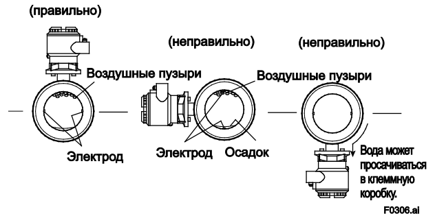
Рисунок 3.1.6 Ориентация при монтаже
