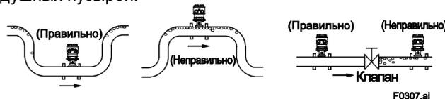
Рисунок 3.1.5 Предотвращение формирования воздушных пузырей
