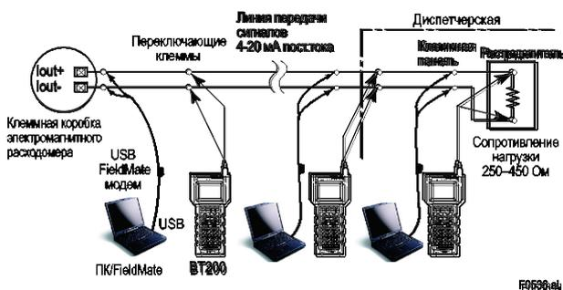
Рисунок 5.6 Подключение инструментария конфигурирования BRAIN
