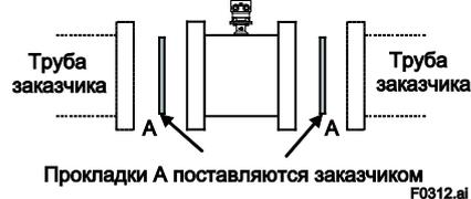
Рисунок 3.3.2 Установка без колец заземления
