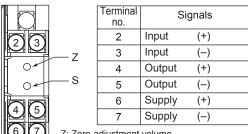
Output (+) 2 Output 3 (-)4 Input (+) 5 Input (-) Supply (+) 6 Supply 7 (-)
