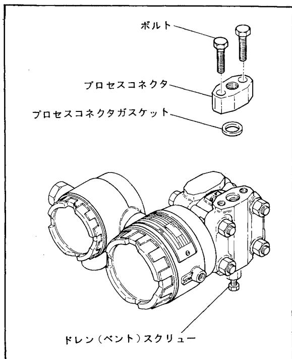
図6.8 プロセスコネクタ部の分解図
