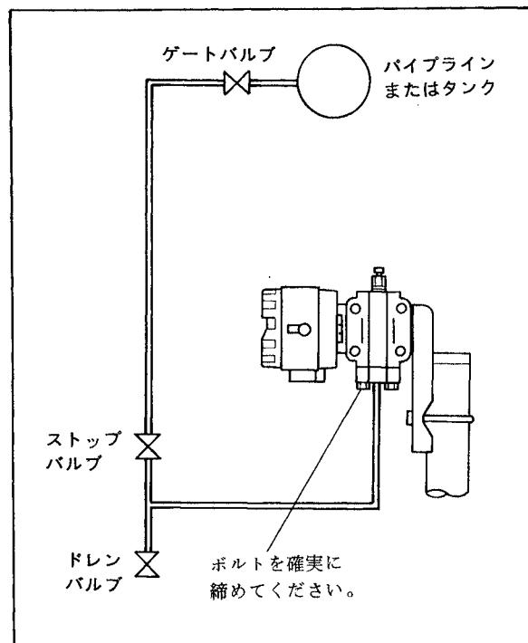
図5.1 導圧配管の例-1
