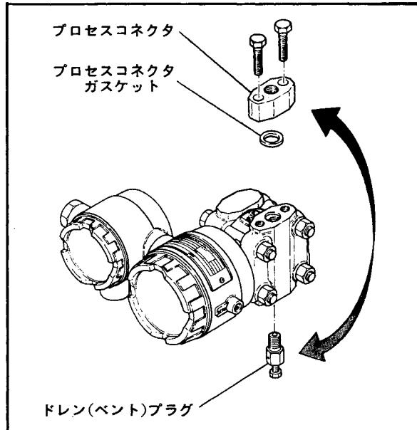
図3.2 プロセス接続を下側にする場合
