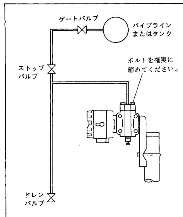
図5.2 導圧配管の例-2
