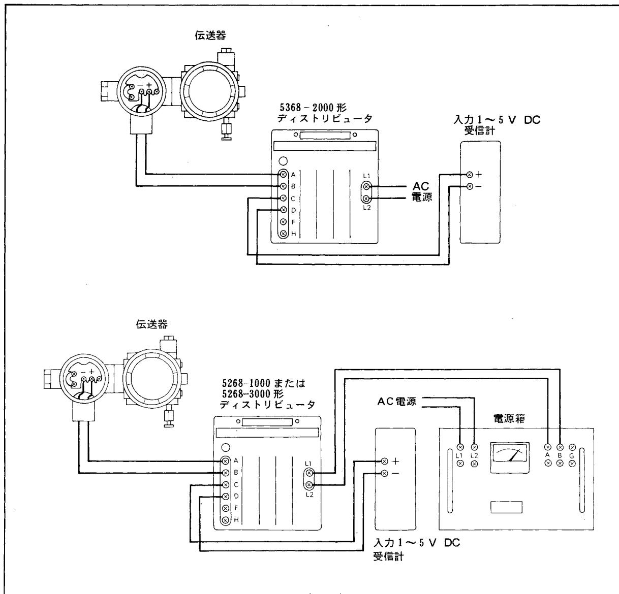
図 4.2 伝送器とディストリビュータの接続 (4~20 mA ADC 信号)
