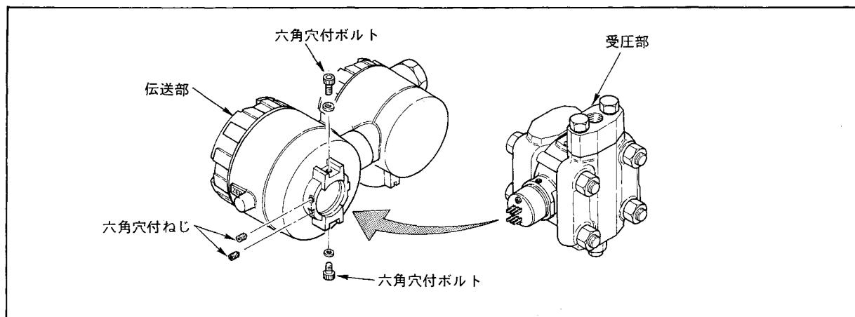
図 1.3 送信部と受圧部を固定するための取付ねじ
