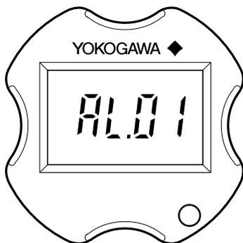
図6.1 内蔵指示計による異常確認
