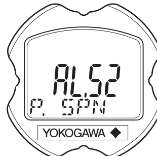
図8.8 内蔵指示計による異常確認
