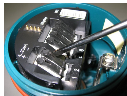
②レバー溝にドライバーを挿入する
