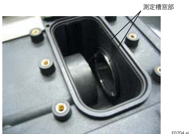
図7.4 検出器測定槽内部
