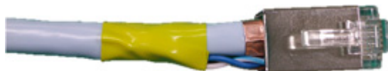
図 5.30 FC33 複合ケーブル LAN インターフェース部の 成端手順(1)-(12)湯川
