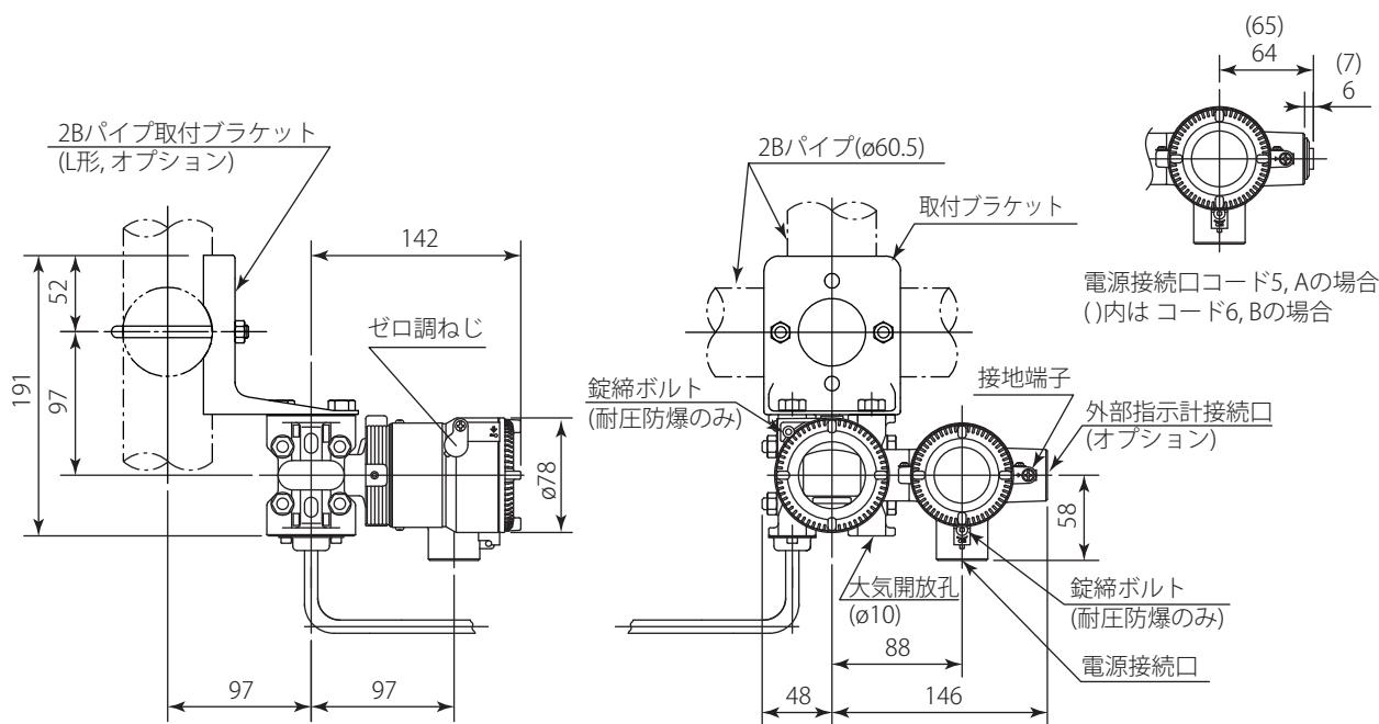
\*1：電源接続口コード7またはCを選択した場合、ブラインドプラグは接続口から最大8 mm突出します。
