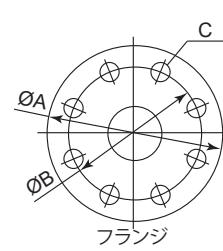
\*1 フランジガスケットが比較ガス出口をふさがないことを確認してください。必要に応じてフランジガスケットを切り欠いてください。
