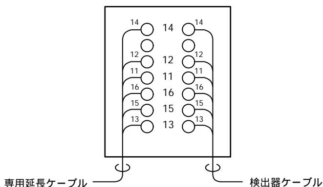
注：本品（1組）は、専用延長ケーブルをコンジットで保護する場合に使用します。
