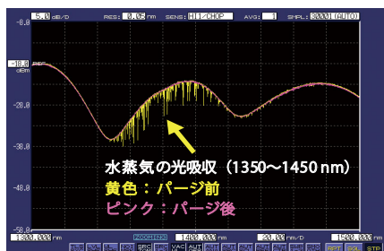
パージによる光吸収の低減効果
