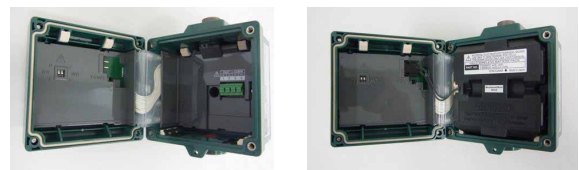
図 4 FN310 の内部構造 (左: 電池パック無)
